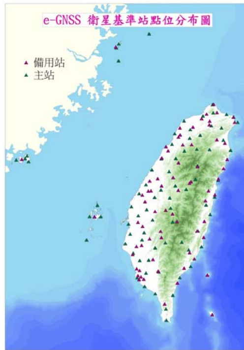
圖1 e-GNSS系統主站及備用站分布圖
