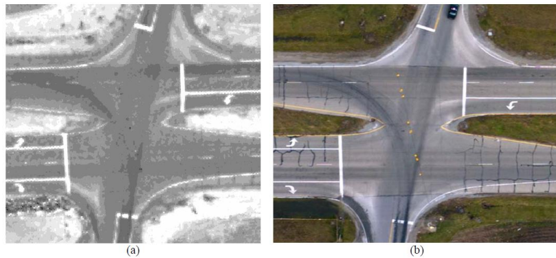
圖 6-2 Toth 等(2008)利用道路標線評估光達幾何精度
