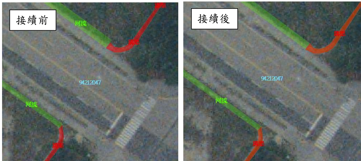
圖 8-10 水系接續編修示意圖
