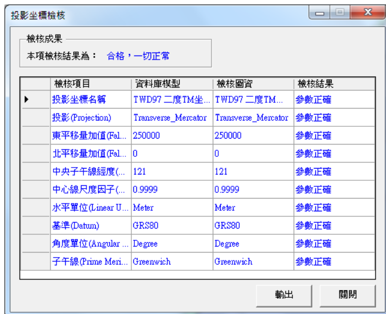
圖 6-21 投影坐標系統檢核顯示畫面
