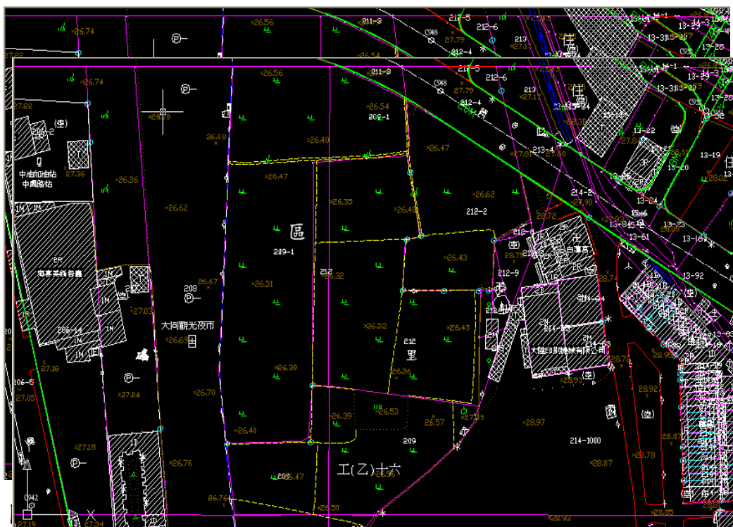
圖 4-21 港子坪段地形套疊地籍成果圖(紅色線:地籍線 黃色線:地形線)
