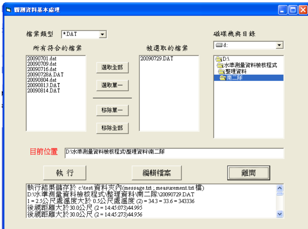
圖 3-2：水準測量資料檢核程式執行畫面
