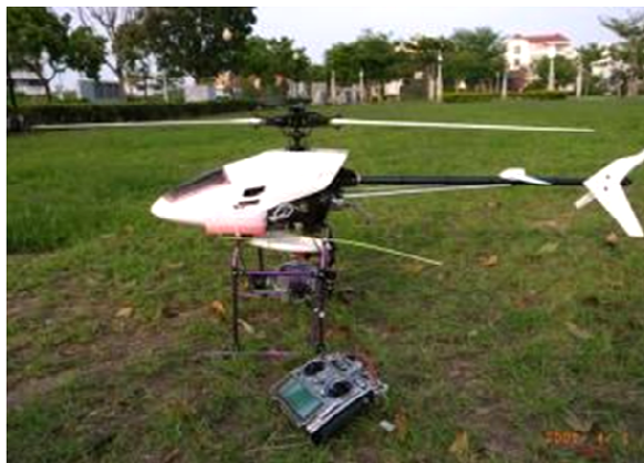
圖 3-3 遙控空拍直升機
