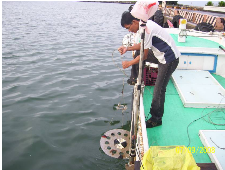
圖 54、Barcheck 作業實況
