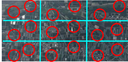
圖 3.3-2 空中三角量測點位示意圖
