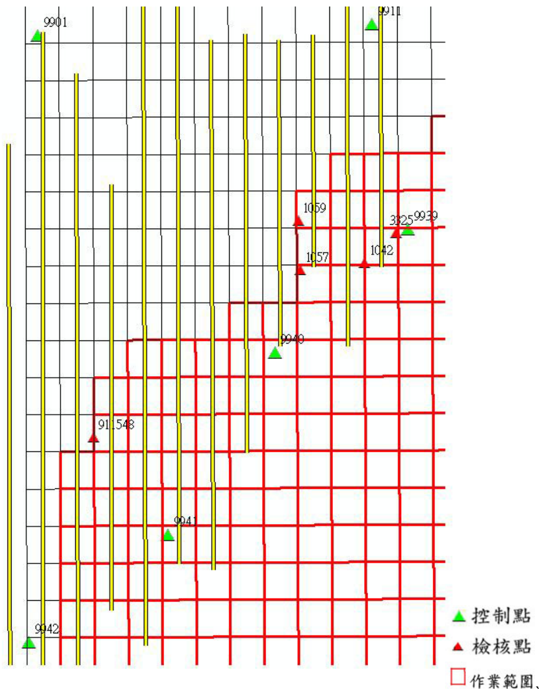
圖 3.4-5 BLOCK1 空中三角測量控制點分布圖
