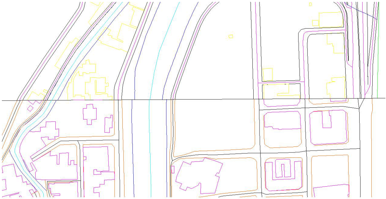
圖 5.2-3 立測底圖未接邊示意圖
