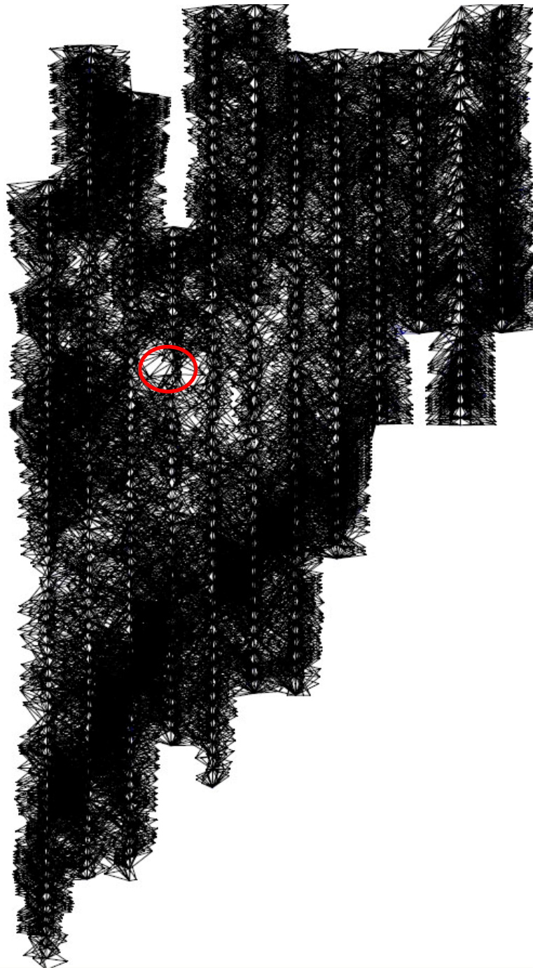
圖 3.4-2 ADS40 之 BLOCK1 空中三角測量連接點網形
