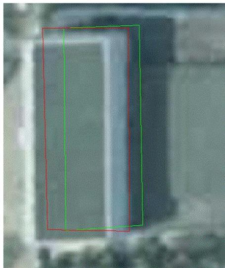
圖 3.6-19 改良式數化法示意圖(紅線為屋頂位置，綠線為屋底位置)
