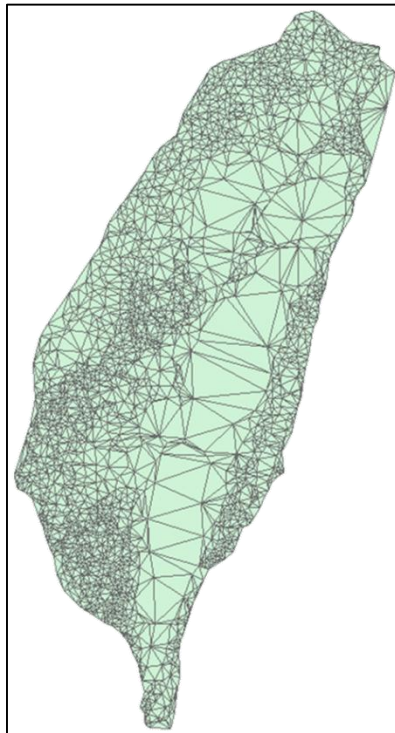
圖 3-78 臺灣地區衛星控制點不規則三角網圖形
