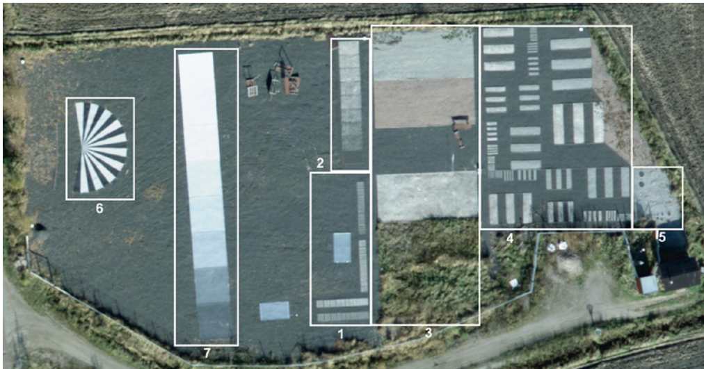
圖 3-8、芬蘭 Sjöckulla 測試場(Test Field)之影像品質校正標
