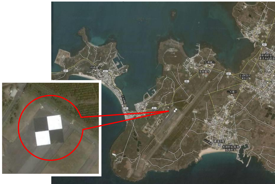
圖 3-17、NSPO 調制轉換函數(MTF)測試標
