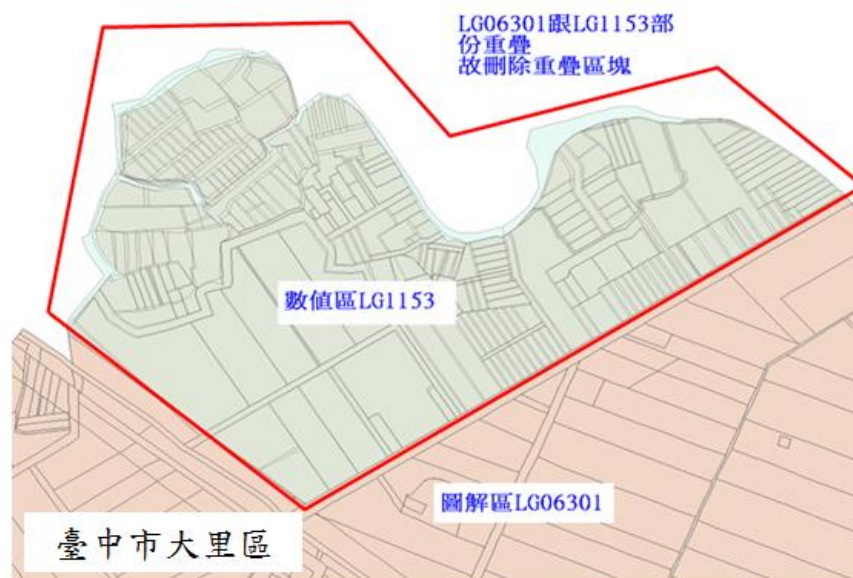
圖 4-20 重疊區域挖除原則（依測量方法）
