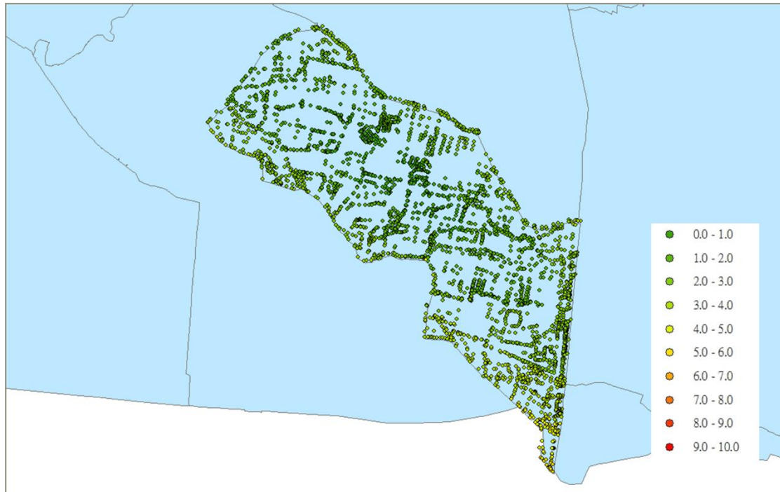
圖 4-86 界址點位移量分布圖 (后里區)
