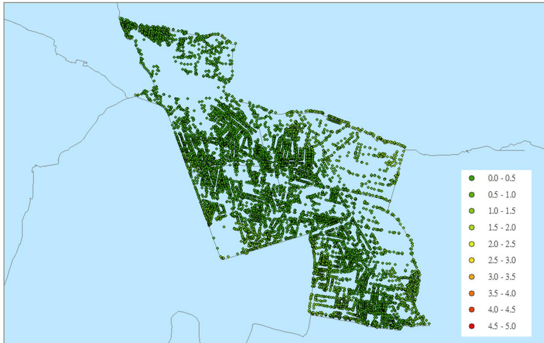
圖 4-90 界址點位移量分布圖（沙鹿區）
