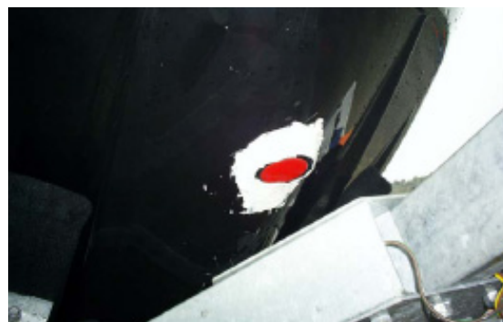
底部鑽洞後安置單音束測深儀
