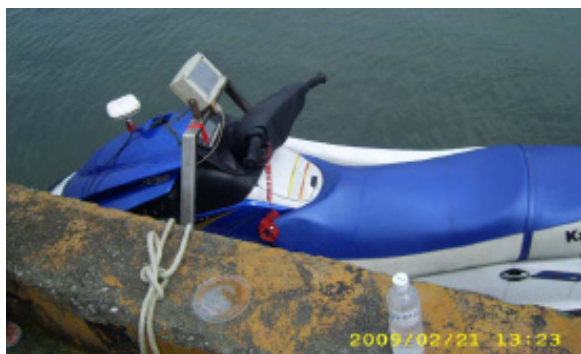
工作電腦與 DGPS 安置
