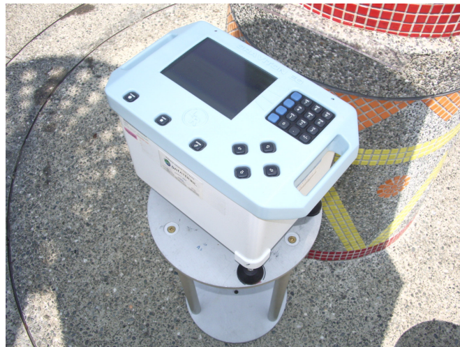
圖 5 重力梯度測量實際作業情形
