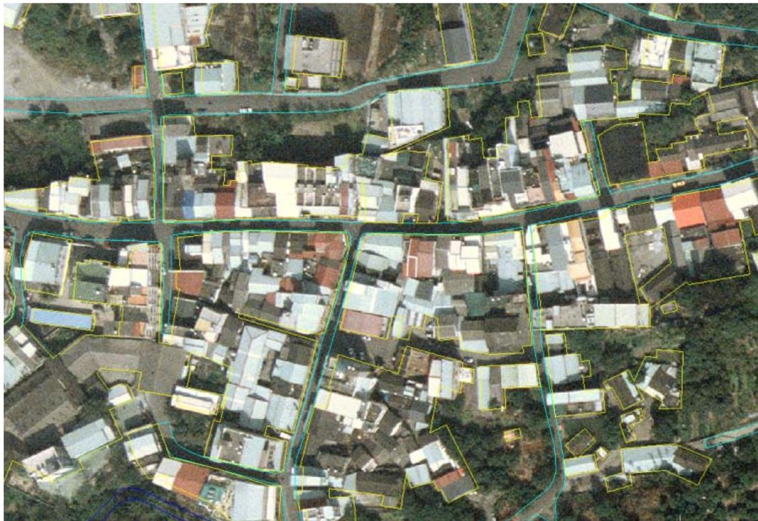
圖 3-22 路邊線以臨街建築線繪製示意圖
