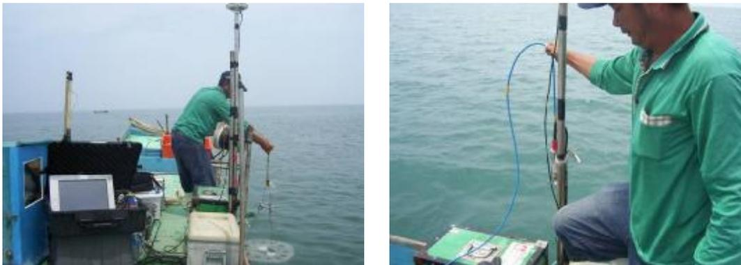
圖 8-17 聲速板檢校校正作業照片
