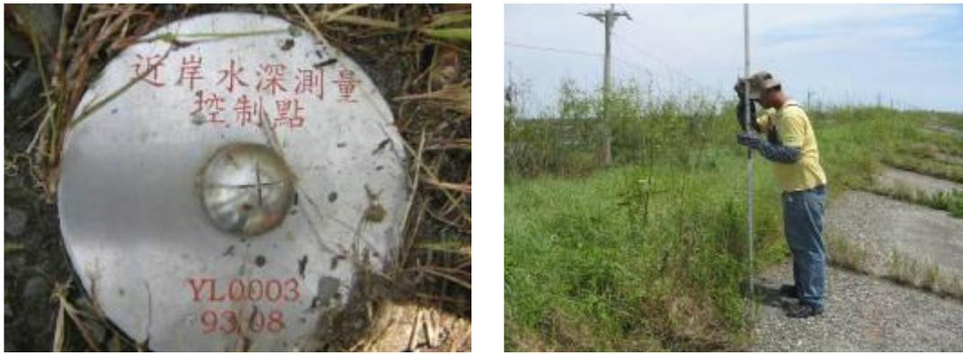
圖 8-7 水準高程點檢測作業照片
