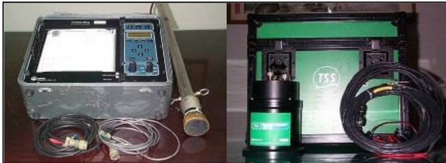
圖 8-18 測深儀（左）與湧浪補償儀（右）
