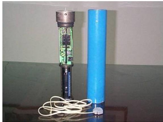
圖 8-14 驗潮站架設情形及自動驗潮儀照片
