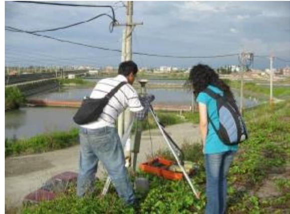
圖 8-4 GPS 控制點檢測作業照
