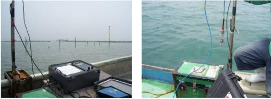
圖 8-16 測深儀器架設情形
