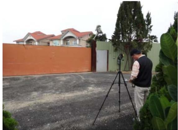
(b)於測站架設雷射測距儀
