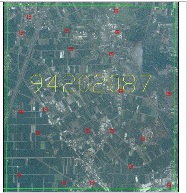
圖 5-37、第 2 作業區幾何精度檢核情形
