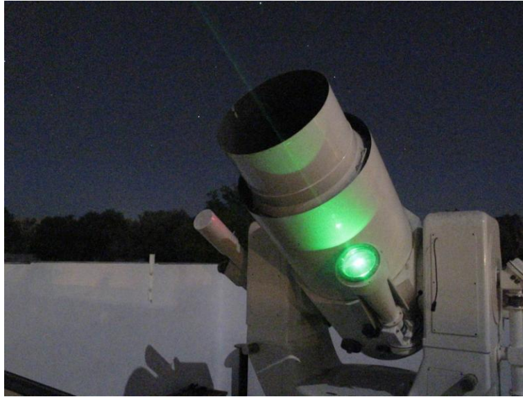
圖 3 SLR 望遠鏡與雷射發射器(San Juan, Argentina)
