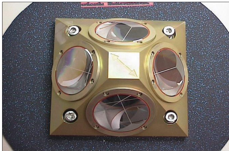
圖 1 CHAMP 衛星上裝設之 SLR 雷射反射稜鏡
