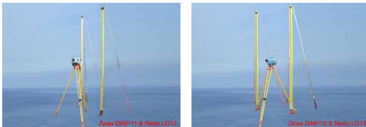
圖 2-2 使用之精密水準儀與鈦鋼水準尺
