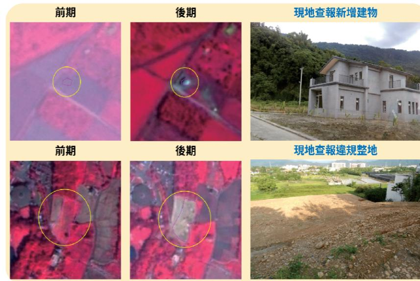
▲ 圖 4-34 衛星影像變異點偵測示意圖
