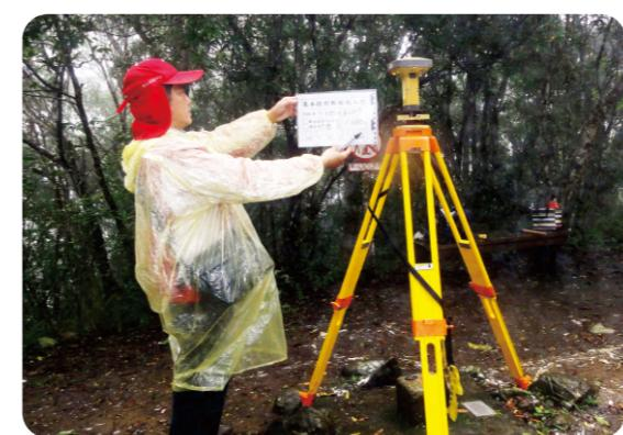
▲ 圖4-1 基本控制點檢測作業情形及點位毀損現況
