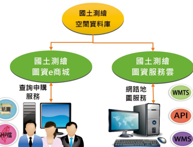
▲ 圖 4-46 測繪資訊整合流通系統關聯架構圖
