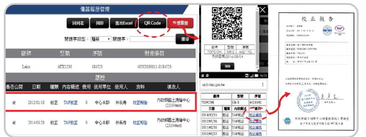
▲ 圖 4-70 測量儀器電子履歷QR-Code 使用流程
