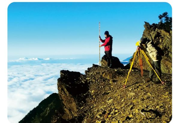
▲ 圖 4-4 玉山主峰正高及衛星測量辦理情形
