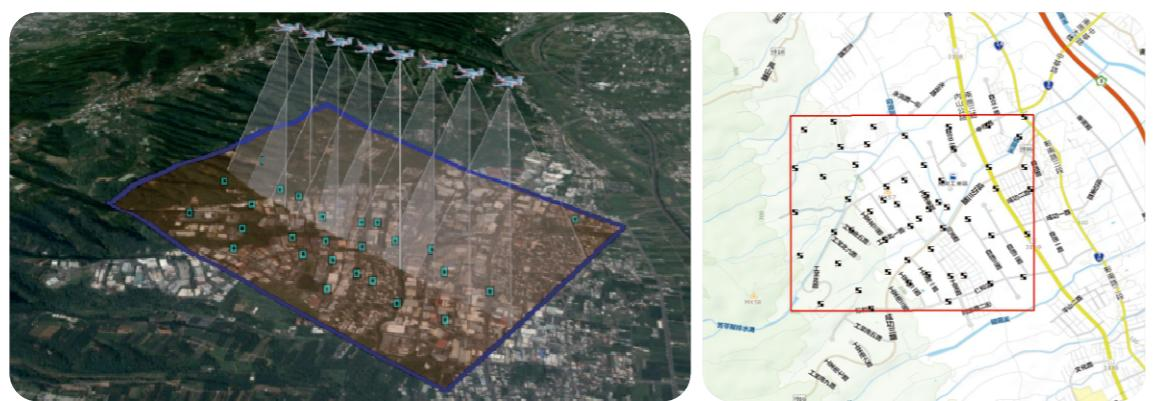
▲ 圖 4-73 航空測量攝影機飛行航拍示意圖及校正場範圍
