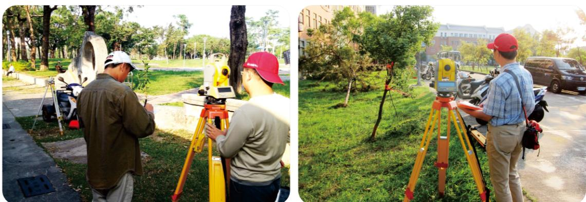
▲ 圖 4-69 簡易電子測距基線場檢測標準距離作業情形
