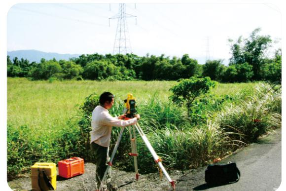
▲ 圖 4-25 台電鐵塔用地預為分割實地測量情形
