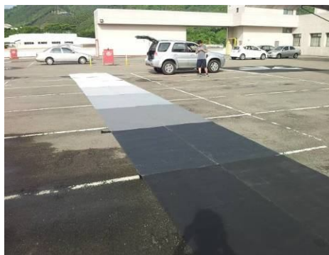
圖 3-10、空間解析力校正標樣式規格
