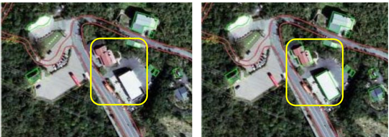
(a)套疊正射影像，檢視地物變遷情形 (b)正射數化更新，新增建物後成果
