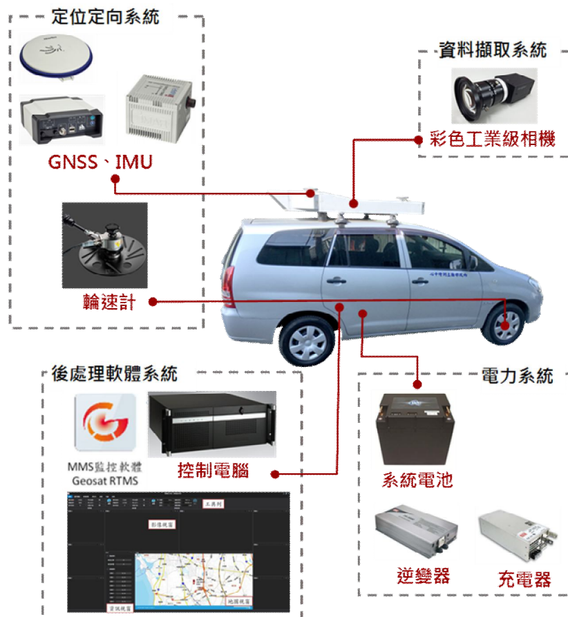
圖 4-6、本中心 MMS 組成架構示意圖
