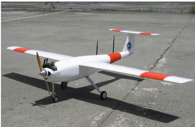
圖 4-2、定翼型 UAS (國土測繪一號)
