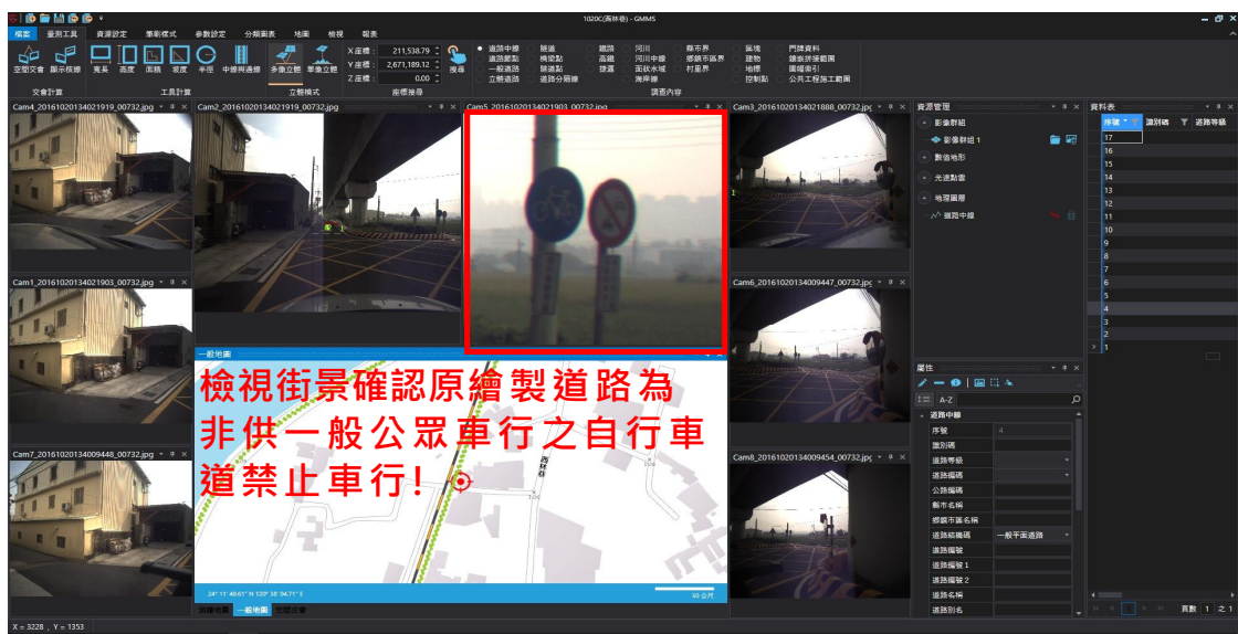
圖 6-42、「臺中市西屯區高鐵橋下聯絡道新闢工程」GMMS 數化道路邊線作業畫面示意
