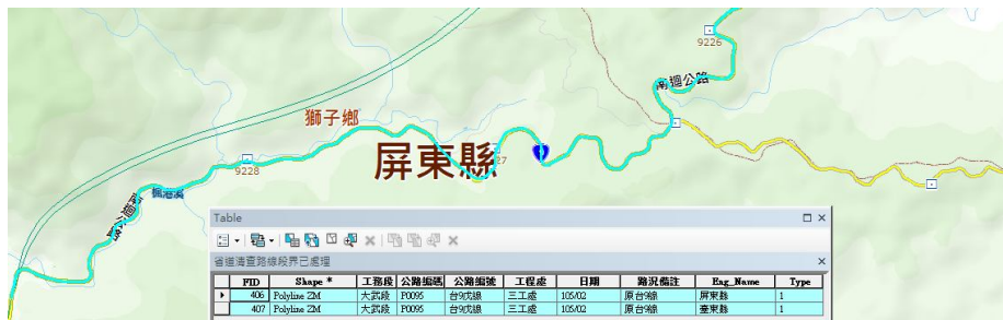
(a)套疊參考圖資於既有向量，針對異動處進行道路編號修正
