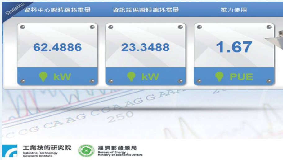
圖 9-4 至善樓機房電力使用監視系統畫面
