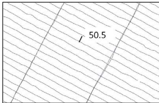
圖 3-21 單音束測深測線間距
