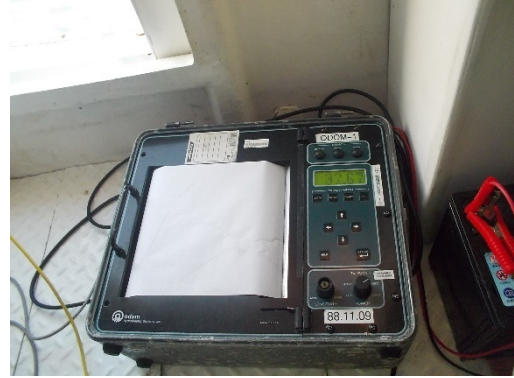
ODOM_10051 單音束儀器架設照片
