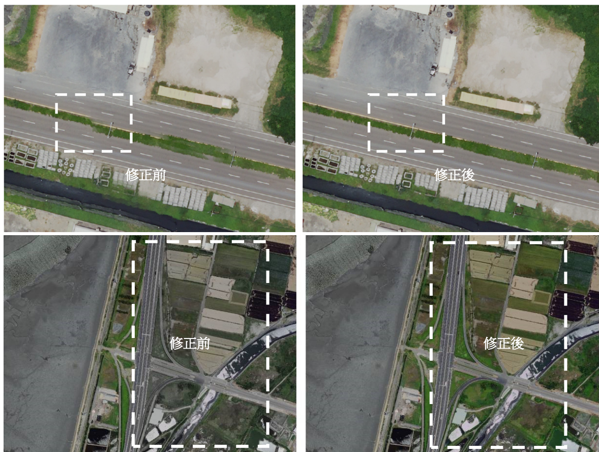
圖3-47、正射影像接邊修正(上)及色調一致性修正(下)樣張
