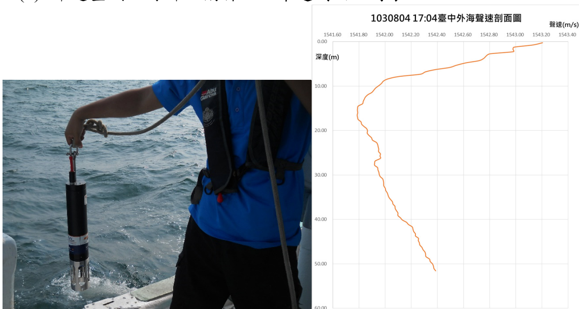
圖3-72、聲速剖面量測情形(左圖)及聲速剖面圖(右圖)
