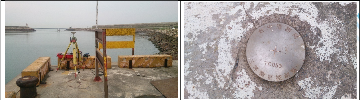
圖3-65、水深測量GPS陸上固定站架設照片
