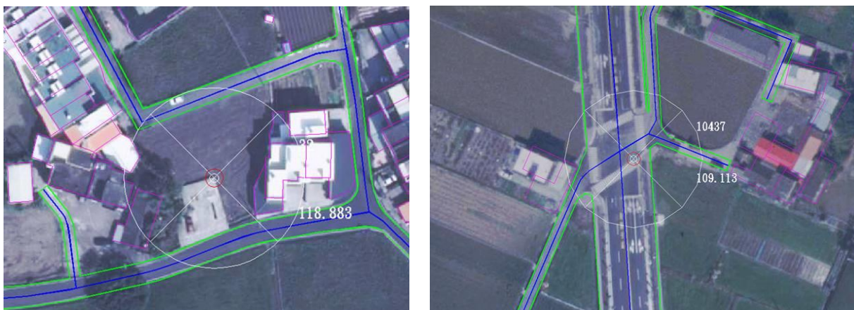
圖 4.7-2 以航測特徵位置檢核正射影像範例
