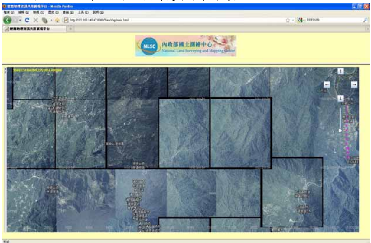
圖 19. 正射影像圖資料問題 1:正射影像圖的原始參數接邊不符，造成有黑邊
