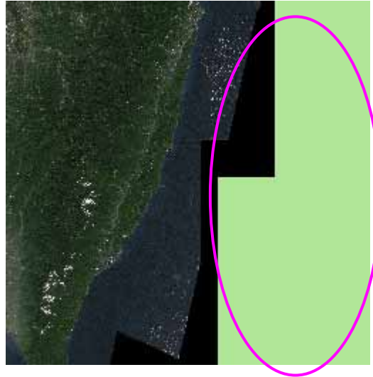
圖 53. 金字塔圖像有部份沒有正射影像，此時 JPG 格式僅能用預設的底色填滿，而無法設定透明色。
