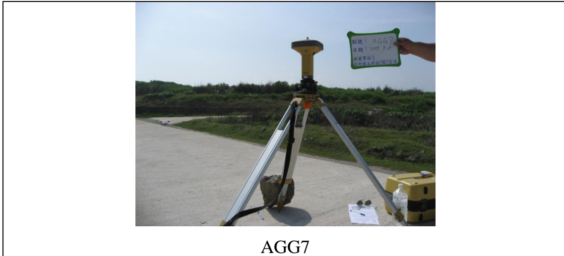
圖 2-6 GPS 基站現場照片 2
