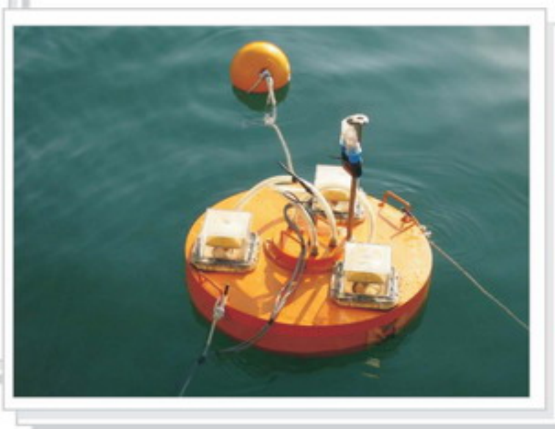
▲ 圖4-73 GPS浮標作業情形
