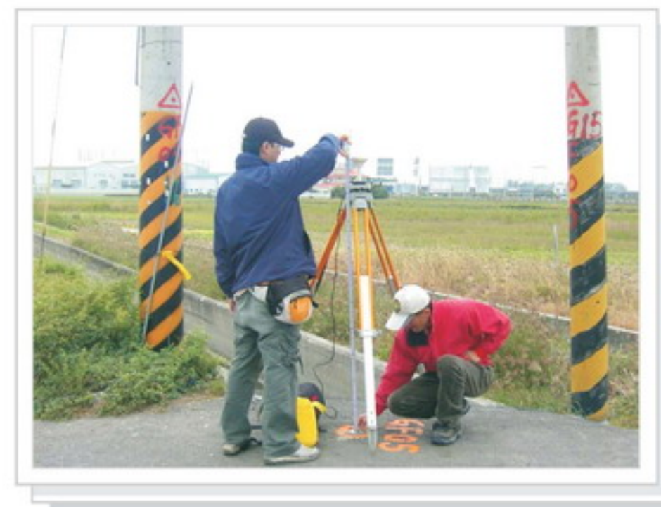
▲圖4-67 新市測試區辦理低成本單頻GPS衛星接收儀外業觀測情形
