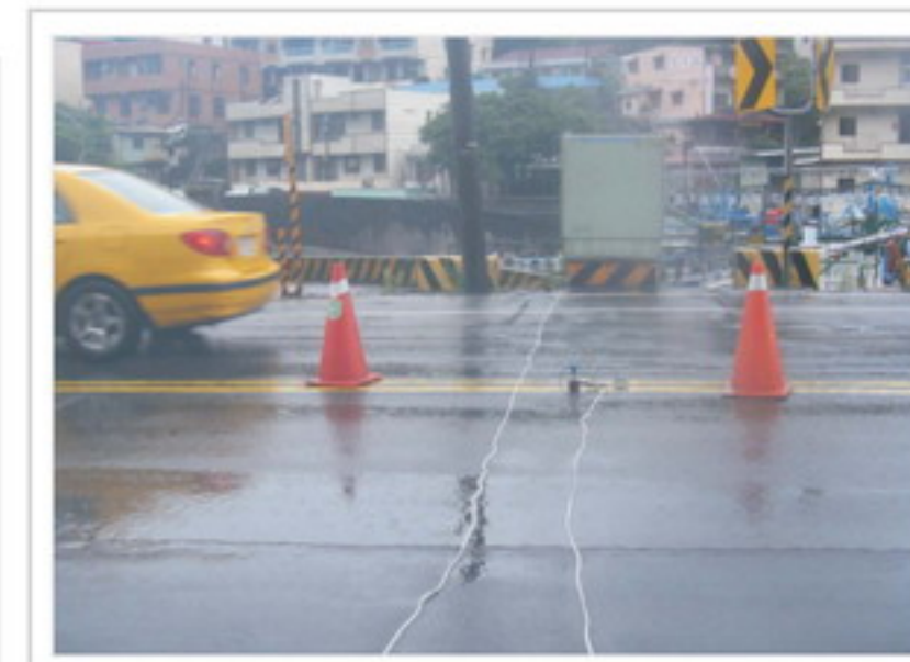
▲圖4-9 水準原點位址探勘-折射震測勘測作業
