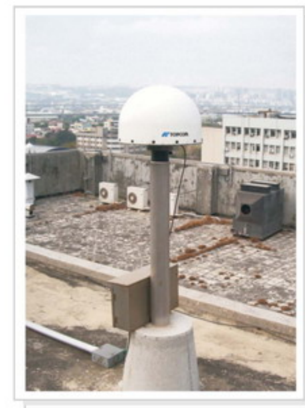
▲圖4-65 衛星定位儀校正場
