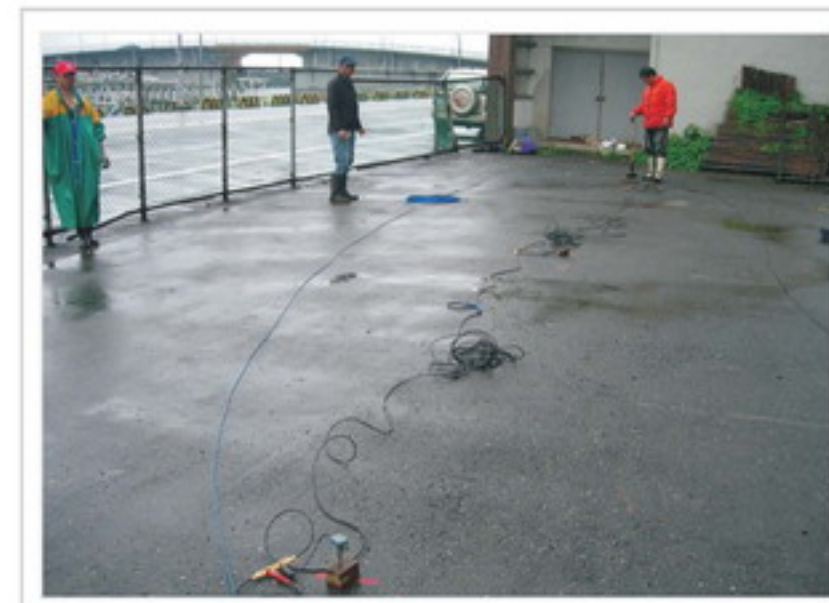
▲圖4-9 水準原點位址探勘-折射震測勘測作業
