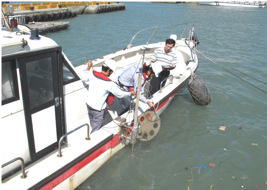
圖 4-16 現場測深作業檢查 (Bar Check)
