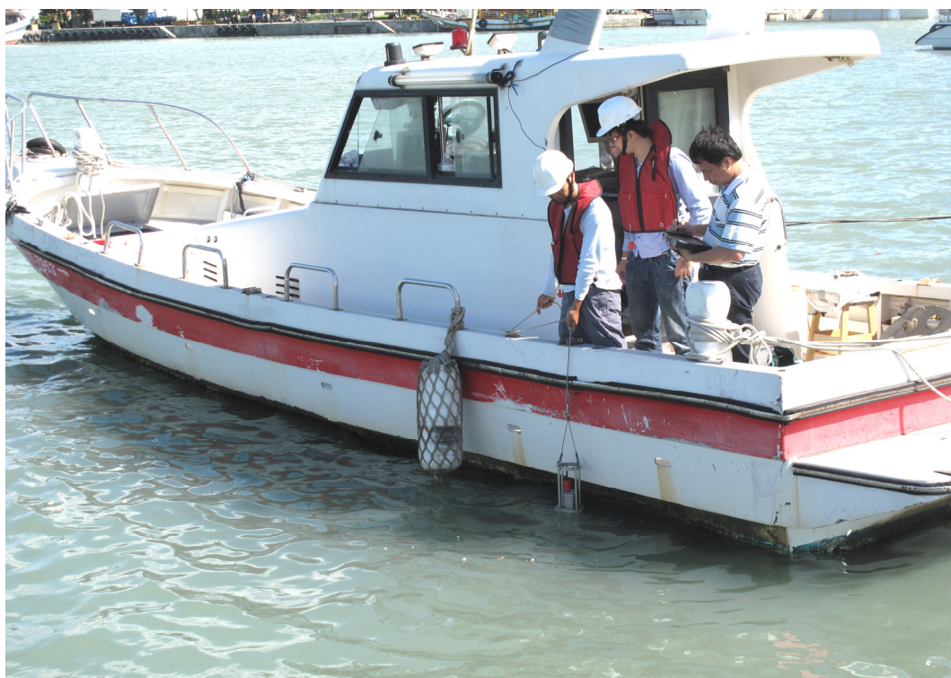
圖 4-17 現場測深作業檢查 (聲速剖面)
