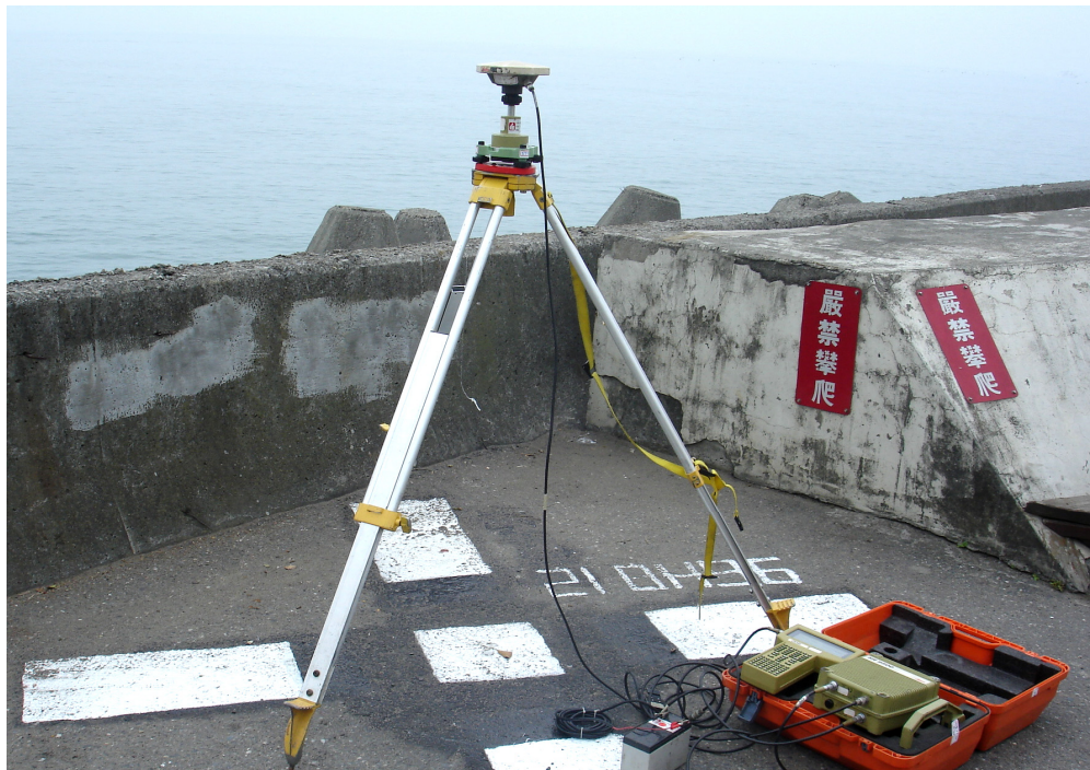
圖 3-3 基地站架設 GPS 儀器
