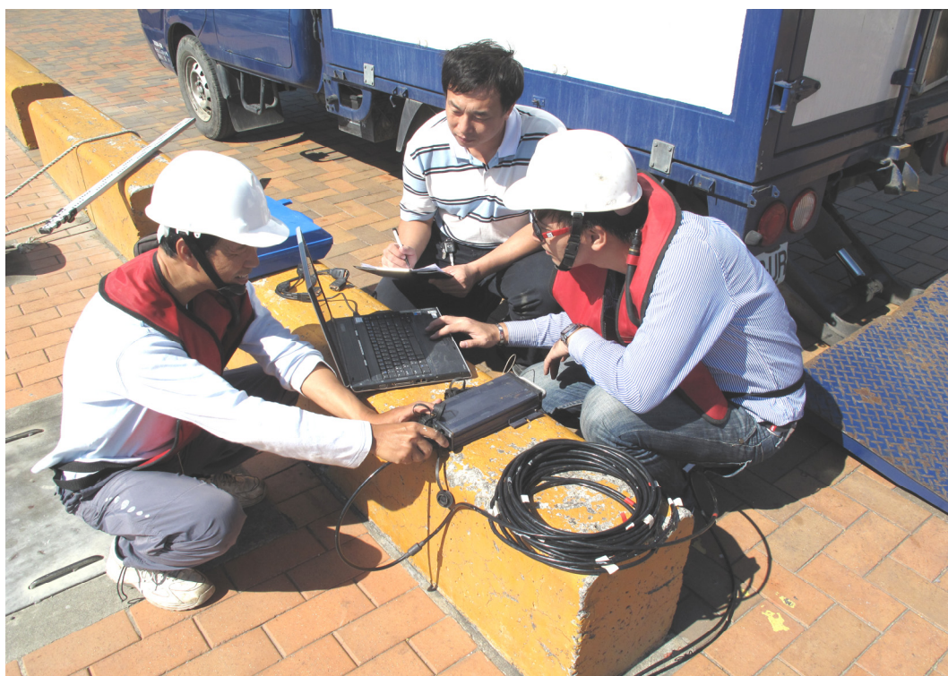
圖 4-15 現場驗潮作業檢查（資料下載）
