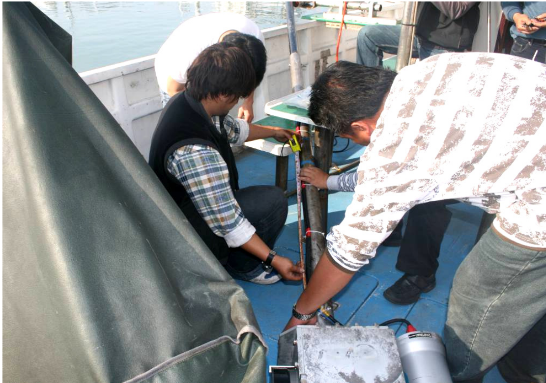
圖 3-6 測深儀裝載情形
