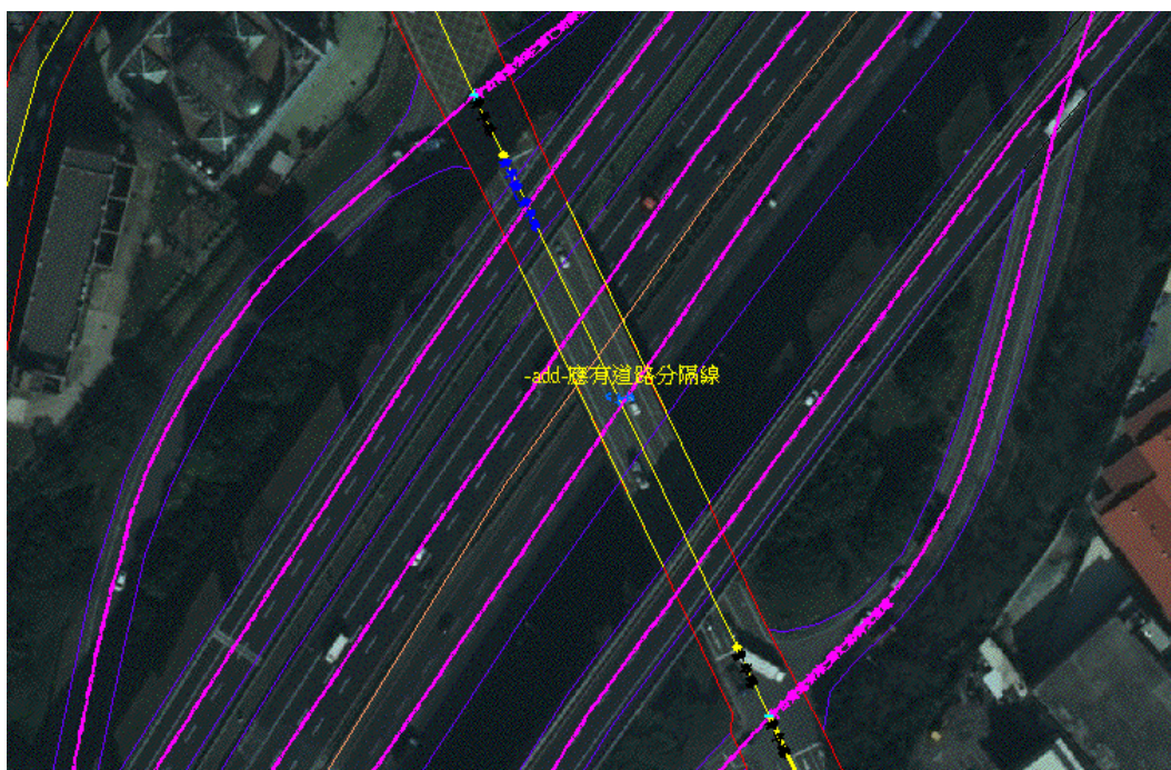
(b) 此處一般道路面位於立體道路面之上，需以道路分隔線加以區別
