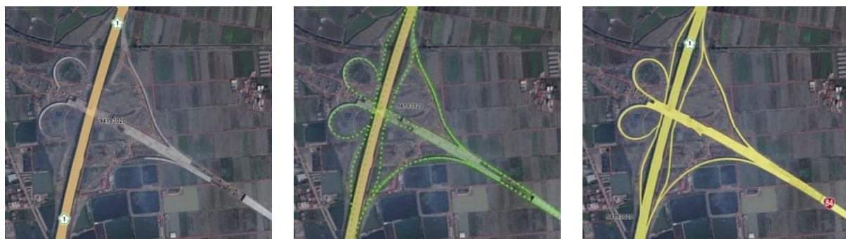
a. 台 84 交流道系統更新前 b. MMS 成果套疊現有道路 c. 產製道路更新成果
