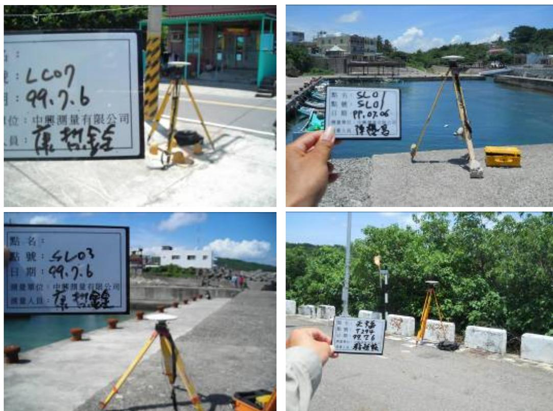
圖 2 小琉球 GPS 驗收實際觀測照片圖
