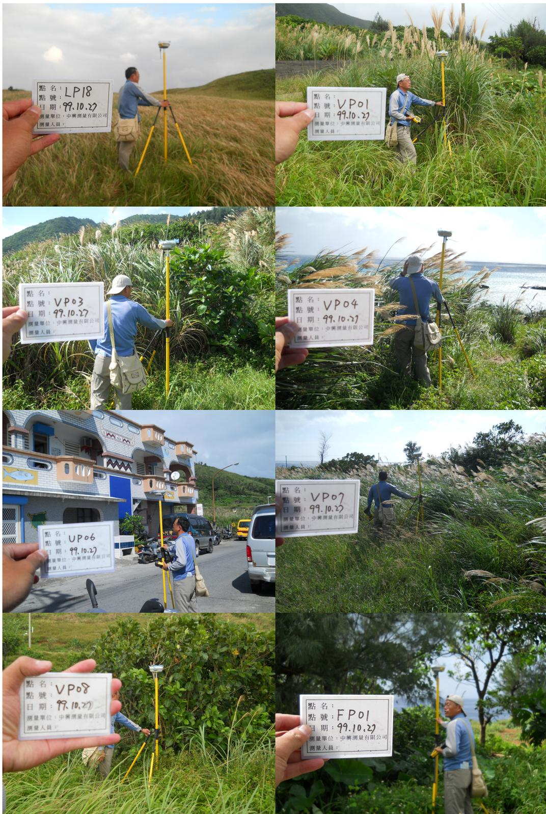
圖 3 蘭嶼實地抽驗地面檢核點位實際觀測照片圖(續)
