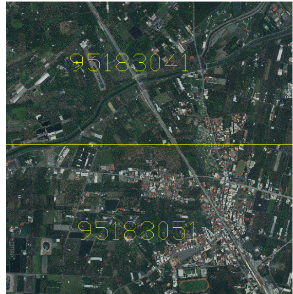
圖 5-31、第 2 作業區影像接邊檢核情形
