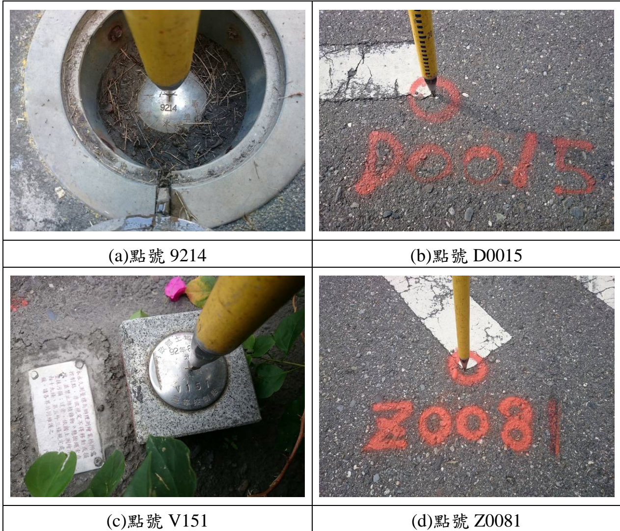
圖 5-9、第 2 作業區第 3 批次控制測量成果抽驗點位照片
