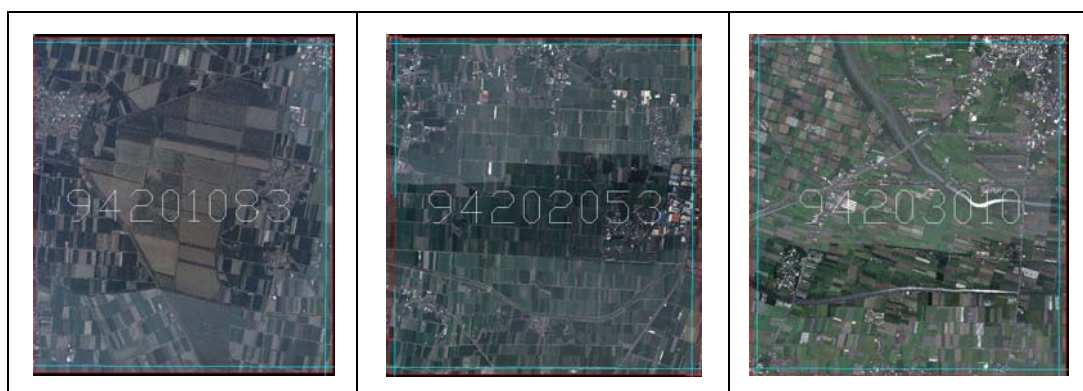
圖 4-9、單幅正射影像色調未平衡
