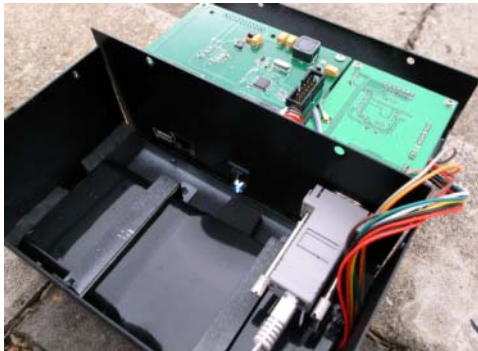
圖 5-40 多頻段差分修正訊號接收模組訊號輸出表示圖
