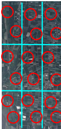
圖 3.3-1 空中三角量測點位示意圖
