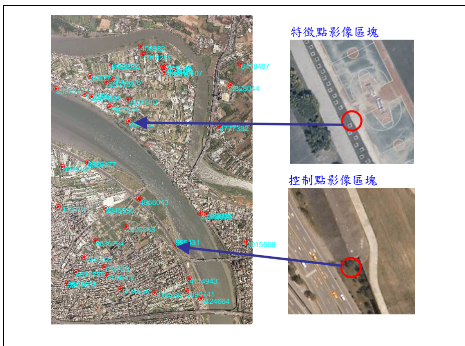
圖 3.10.2-1 待解算影像連接點量測示意圖
