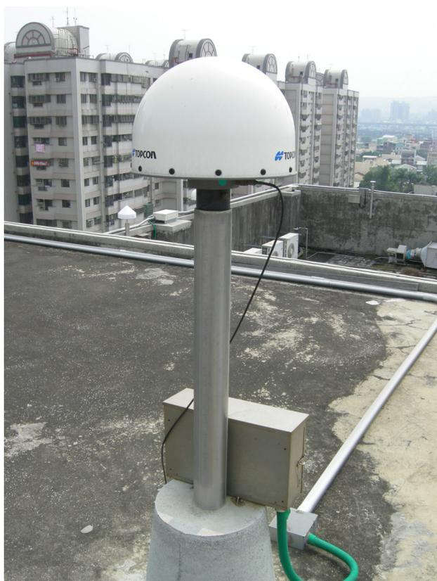
圖3-4 固定基點LS08基樁設置型式
