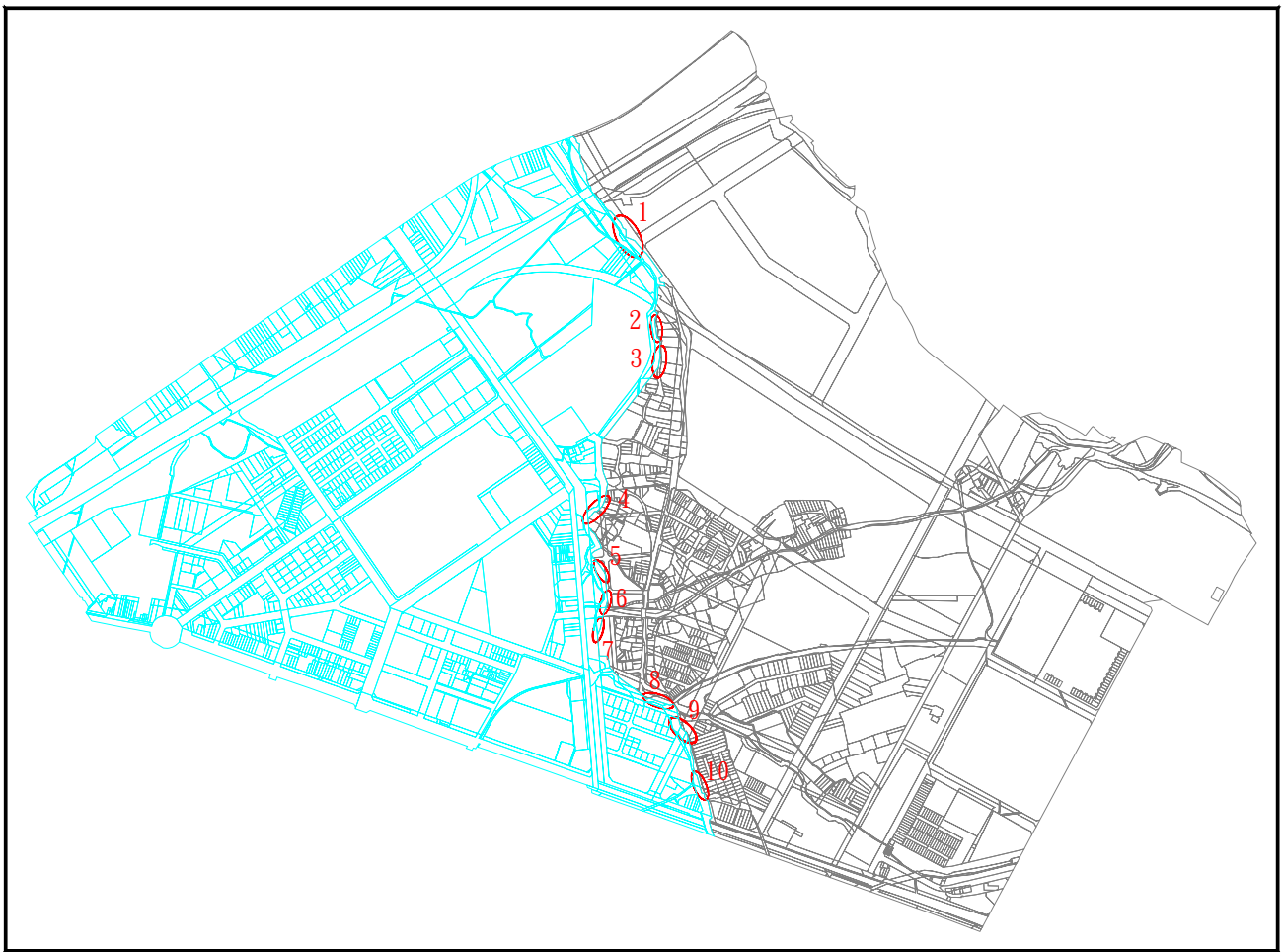
圖 2-21 東光與東明段重疊或脫開情形示意圖
