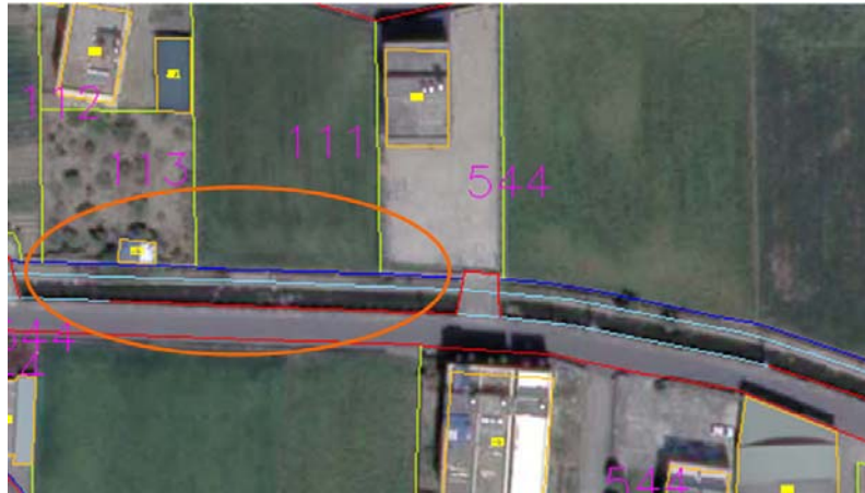
圖 4-26、線段整併：線段間距離超過 3m 者保留
