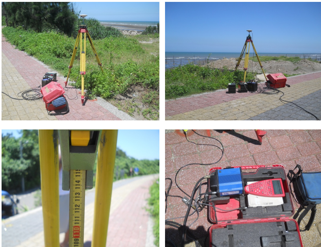
圖3-31、水深測量GPS陸上固定站架設照片
