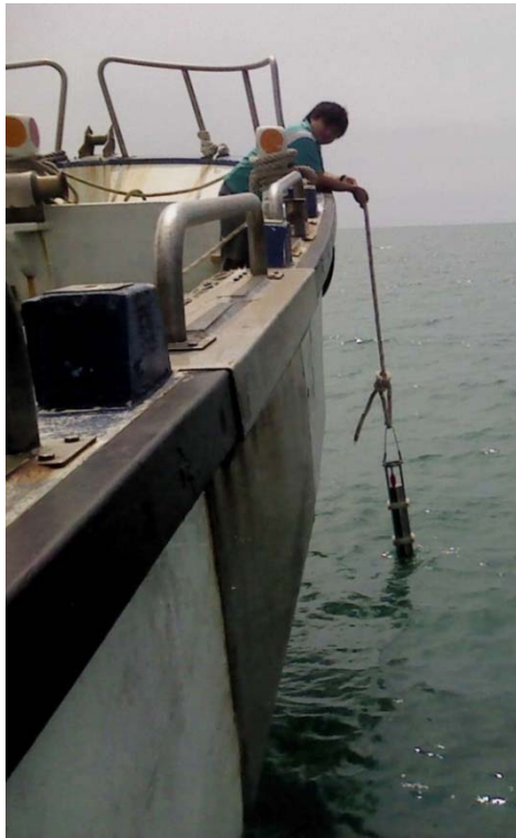
圖3-35、聲速剖面量測情形(左圖)及聲速剖面圖(右圖)
