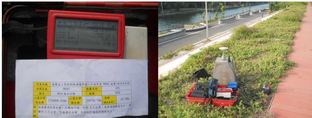
圖3-32、水深測量GPS定位檢測照片
