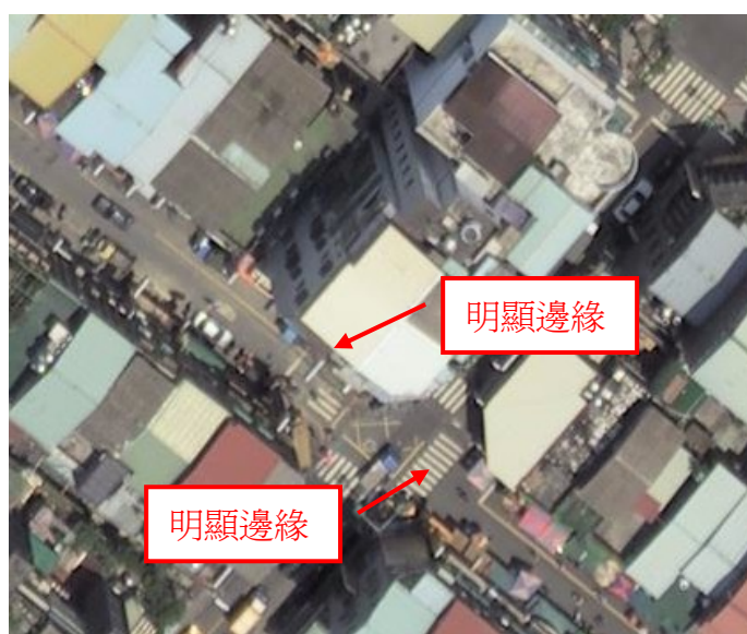
圖 4.1-2 選取明顯邊緣線以估計模糊參數示意圖
