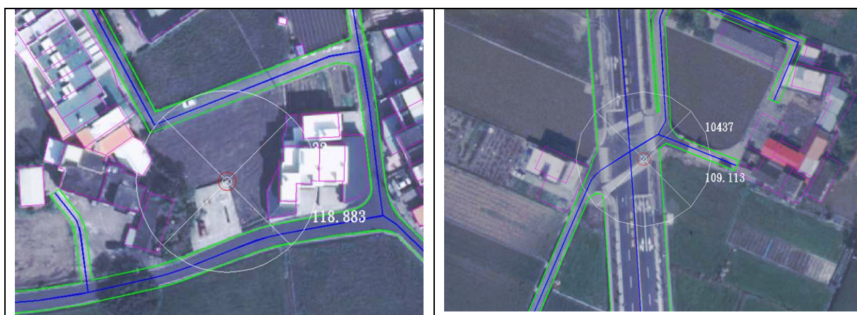
圖 2.1.6-3 以航測特徵點檢核正射影像範例
