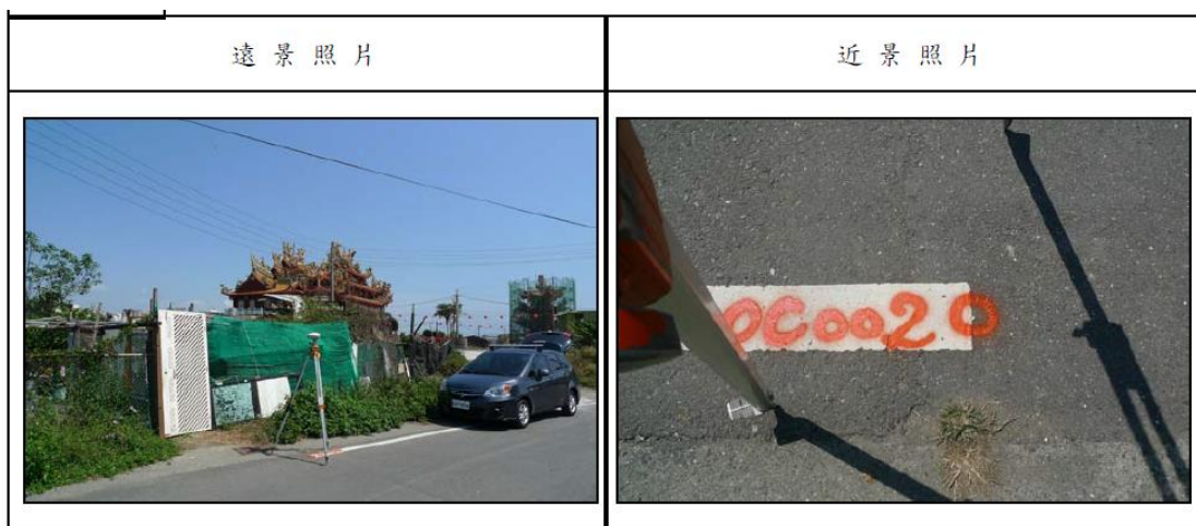
圖 3-6 自然點選設控制點範例(OC002)
