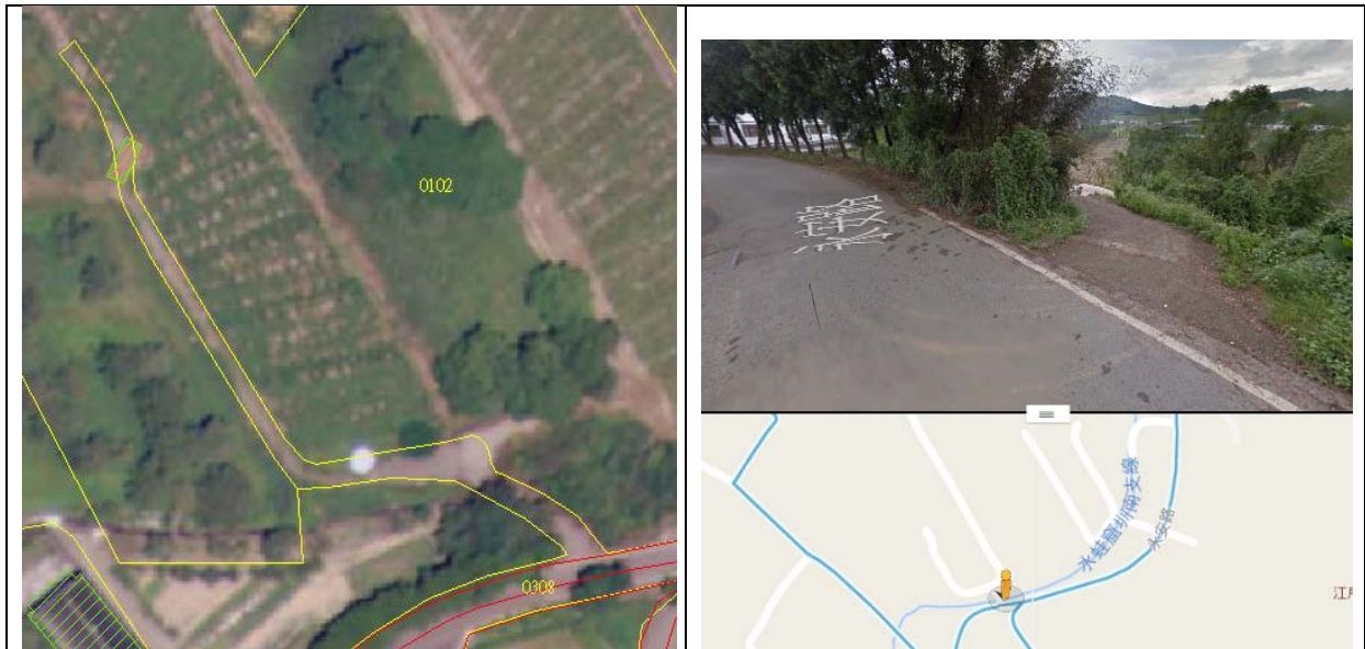
(a)電子地圖缺漏郊區道路(影像上路形不明確)
