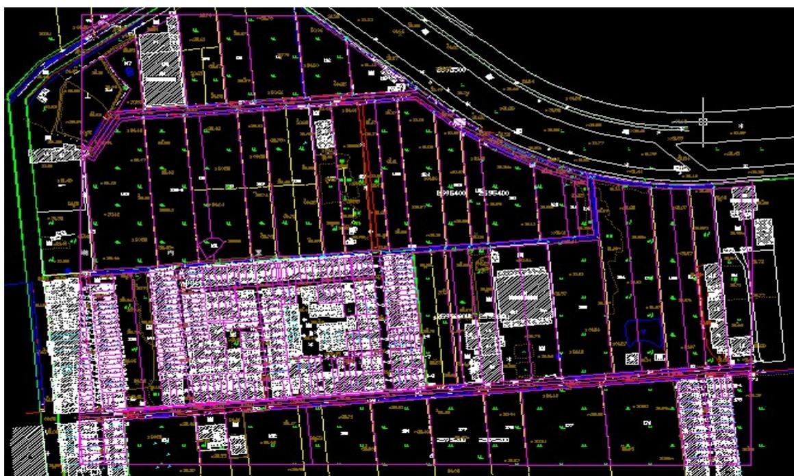
圖 4-13 湖內段第 5 幅轉換後地籍地形套疊圖(紅色線:地籍線 黃色線:地形線)
