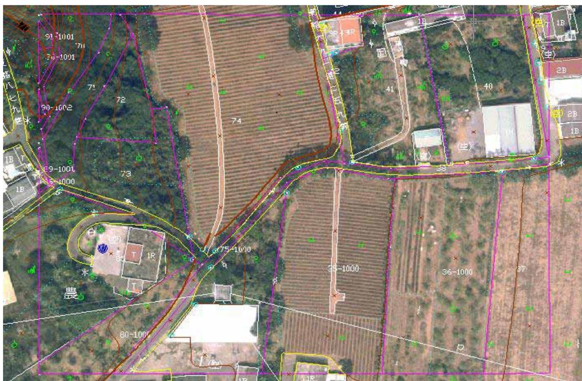
圖 4-52 崎頂段第 15 幅坐標轉換結果套疊正射影像圖(○為現況點)
