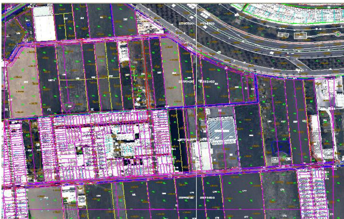
圖 4-14 湖內段第 5 幅轉換後套疊正射影像圖(紅色線:地籍線 黃色線:地形線)
