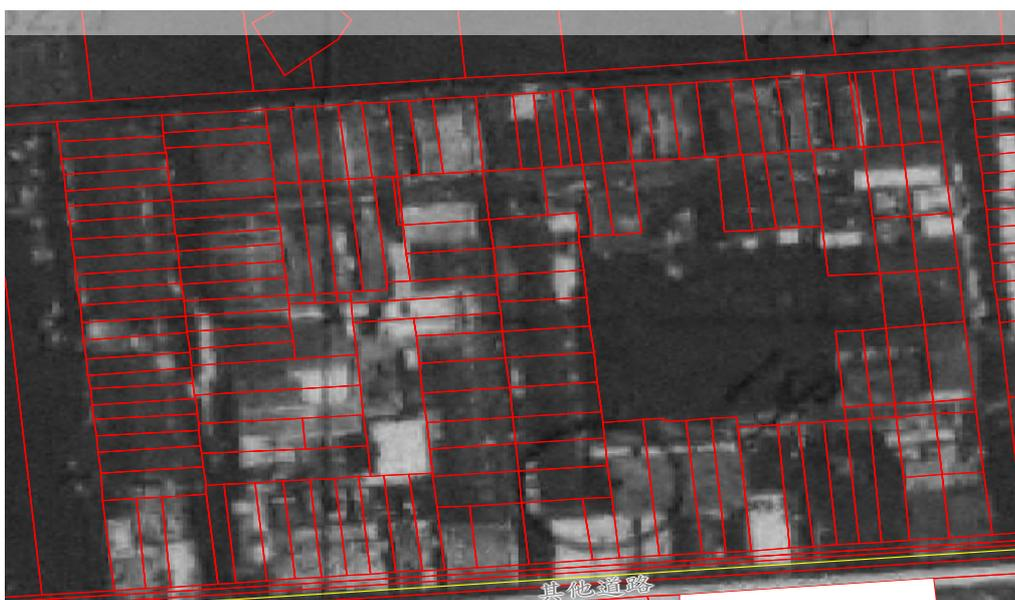
圖 1-3 數化地籍圖與 1/5000 像片圖套疊結果圖(紅色為地籍線)
