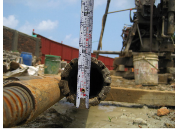
圖 2-8 NQ SIZE 鑽孔
