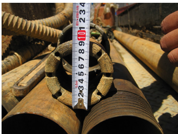
圖 2-5 HQ SIZE 鑽孔
