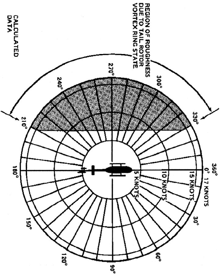
FIGURE 3. TAIL ROTOR VORTEX RING STATE
