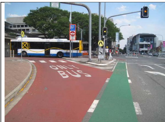
圖 19：布里斯本市區之公車、自行車專用道，均以不同顏色區分警示
