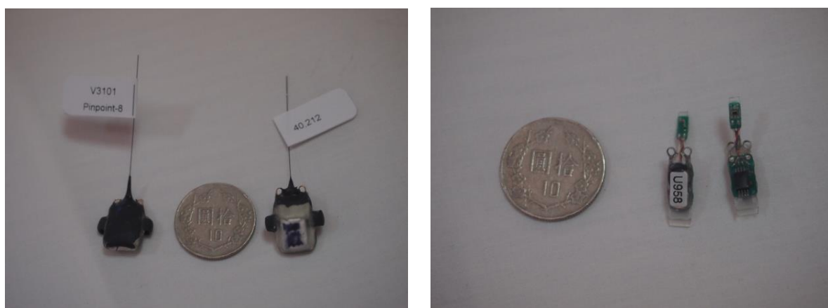
圖 3-3-1 本研究所使用 Pinpoint GPS8(左圖)以及 Geocator(Intigeo P65C2-11)(右圖)。(資料來源：本計畫提供，陳映嵐攝)
